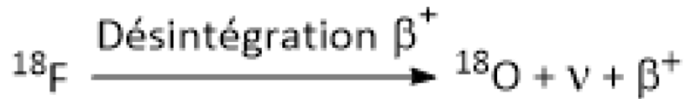
Schéma 1 – Désintégration radioactive du fluor-18
